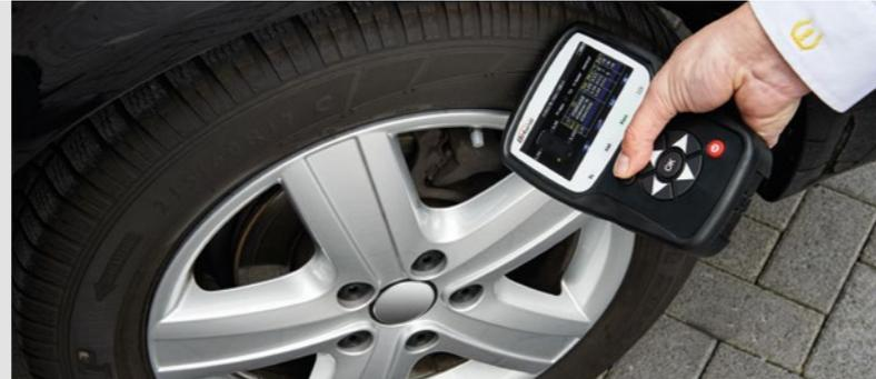
Halten Sie das RDKS-Diagnosegerät an die Reifenflanke in Höhe des Ventils jedes Reifens und folgen Sie den Anweisungen des RDKS-Diagnosegeräts zur Prüfung der Reifendrucksensoren.
