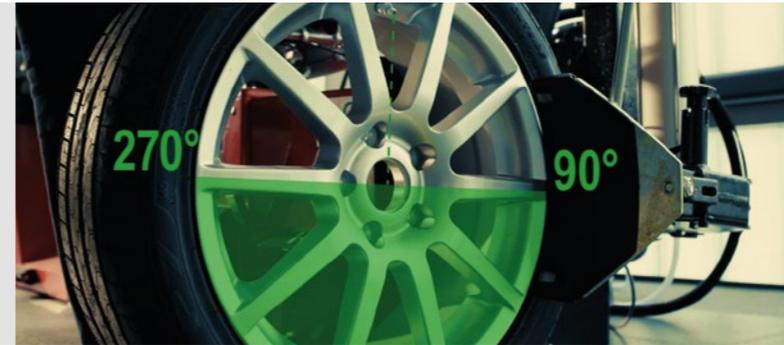
Das Ventil muss in einem Abstand zwischen 90 und 270 Grad zur Abdrückschaufel positioniert und dort beginnend abgedrückt werden.
