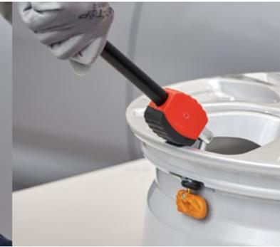
Bestreichen Sie das Gummiventil mit Montagepaste. Achten Sie darauf, dass der Sensor nicht mit Montagepaste bestrichen wird.
