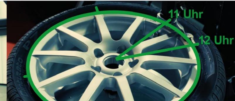
Positionieren Sie den Reifen so, dass das Ventil auf der 11.00 Uhr Position (gesehen vom Montagekopf) steht. Beginnen Sie mit der Demontage der oberen Reifenwulst. Die untere Reifenwulst wird bei gleicher Position des Ventils demontiert.
