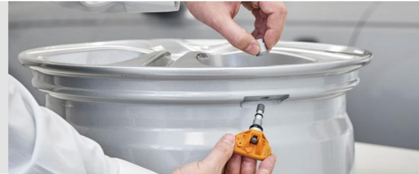
Schrauben Sie den Sensor und das Ventil mit Hilfe der Vierkantschraube von Hand locker zusammen (ca. zwei Umdrehungen). Das Ventil und der Sensor müssen noch beweglich sein.
